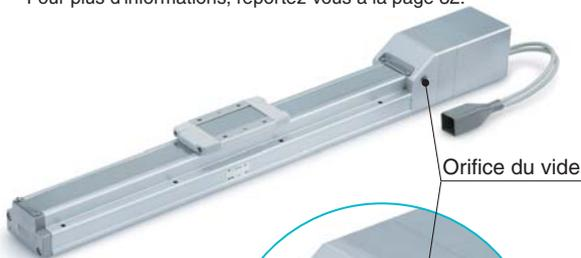
L'orifice de raccordement au vide permet de maîtriser la pollution liée à la génération de particules du guide et de la vis à billes.
