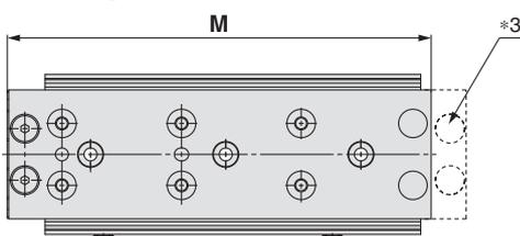
\*3 Da die Gesamtlänge durch Beseitigung der Befestigungsbohrungen für die Hubbegrenzung für das Ausfahrhubende verringert wurde, kann nachträglich kein Ausfahrhubende montiert werden. Die Hubbegrenzungen für das Einfahrhubende können nachträglich montiert werden.
