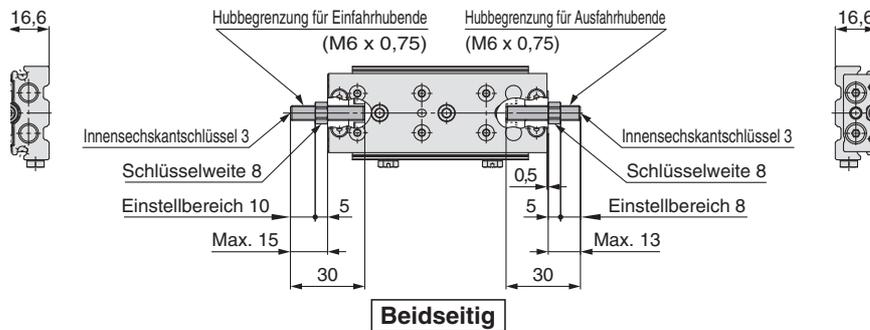
Gummianschlag **ZD** : Beidseitig **ZE** : Ausfahrhubende **ZF** : Einfahrhubende **ZP** : Einfahrhubende (Ausführung mit kürzerer Gesamtlänge)
