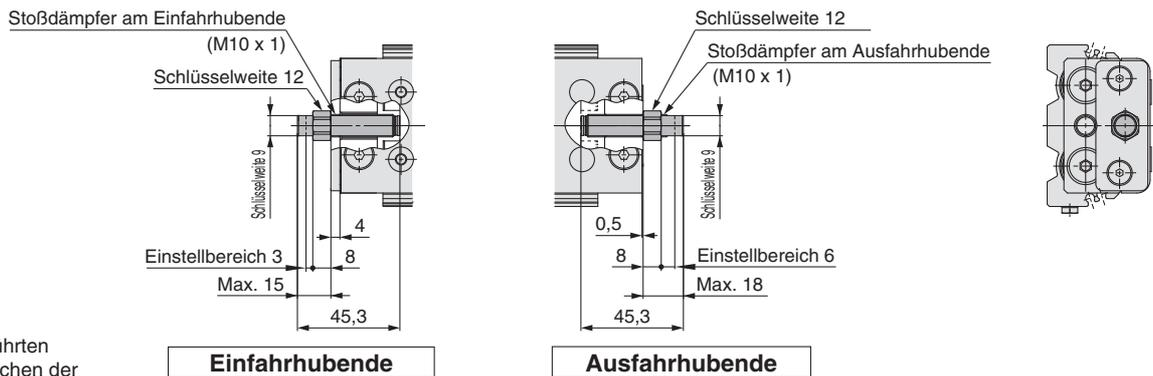
Alle nicht oben aufgeführten Abmessungen entsprechen der Standardausführung.
