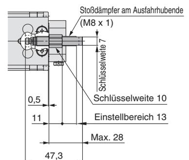
Alle nicht oben aufgeführten Abmessungen entsprechen der Standardausführung.
