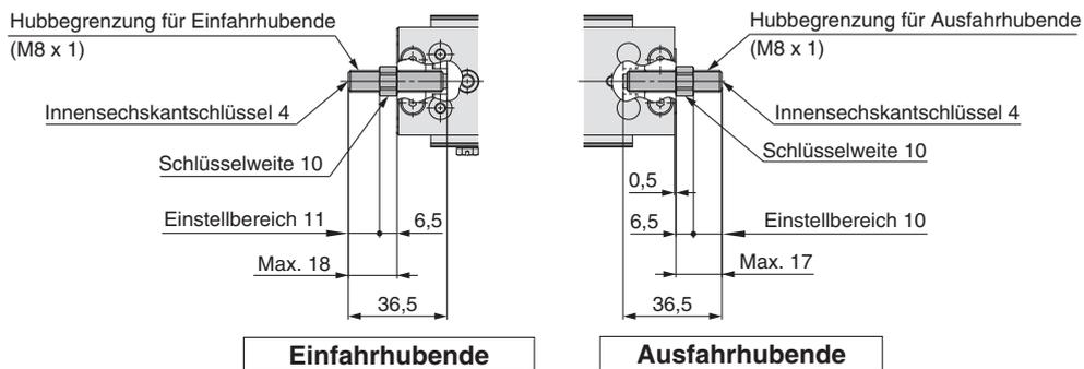
Stoßdämpfer/RJ **ZG** : Beidseitig **ZH** : Ausfahrhubende **ZJ** : Einfahrhubende **ZQ** : Einfahrhubende (Ausführung mit kürzerer Gesamtlänge)
