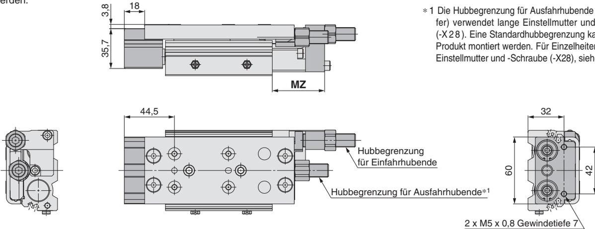
\*1 Die Hubbegrenzung für Ausfahrhubende (Stoßdämpfer) verwendet lange Einstellmutter und Schrauben (-X28). Eine Standardhubbegrenzung kann nicht am Produkt montiert werden. Für Einzelheiten zur langen Einstellmutter und -Schraube (-X28), siehe Seite 130.
