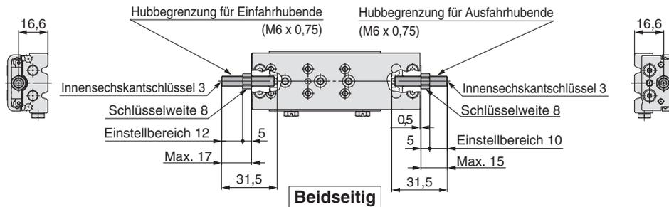
Stoßdämpfer/RJ **ZG**: Beidseitig **ZH**: Ausfahrhubende **ZJ**: Einfahrhubende **ZQ**: Einfahrhubende (Ausführung mit kürzerer Gesamtlänge)
