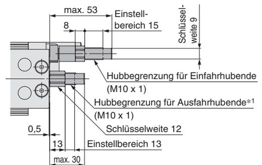
Alle nicht oben aufgeführten Abmessungen entsprechen der Standardausführung.
