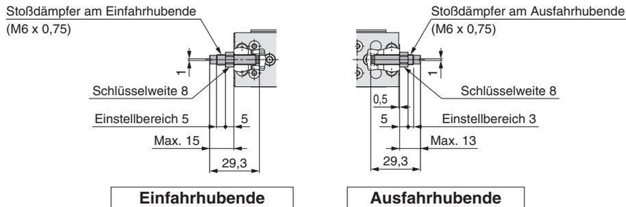
Metallanschlag **ZK**: Beidseitig **ZL**: Ausfahrhubende **ZM**: Einfahrhubende **ZT**: Einfahrhubende (Ausführung mit kürzerer Gesamtlänge)
