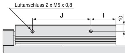
\*1 Bei Verwendung zu langer Schrauben könnten diese Schrauben auf den Führungsblock stoßen und Fehlfunktionen verursachen. Verwenden Sie eine Schraube mittlerer Länge, zwischen max. und min. Einschraubtiefe. Siehe Seite 196 für detaillierte Angaben.
