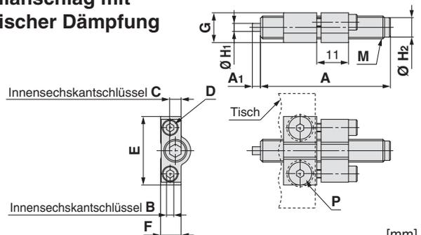
**Metallanschlag mit elastischer Dämpfung**
