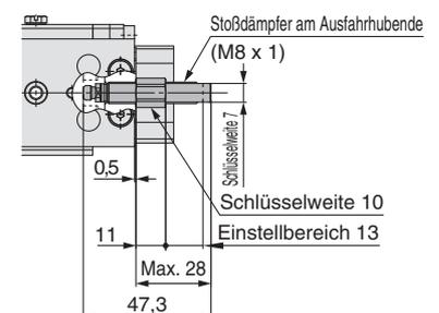
Alle nicht oben aufgeführten Abmessungen entsprechen der Standardausführung.
