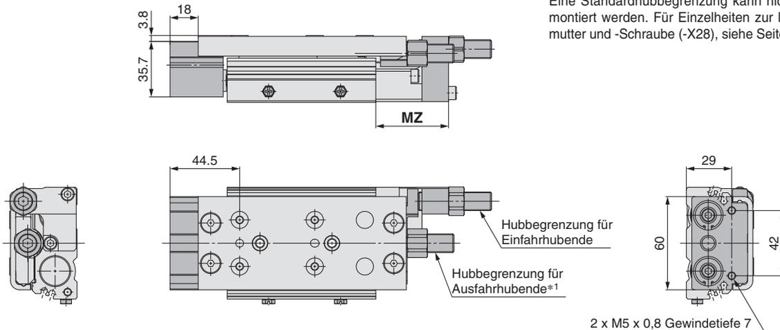
Alle nicht oben aufgeführten Abmessungen entsprechen der Standardausführung. Bei Kurzhüben kann der Signalgeber an bestimmten Punkten nicht montiert werden. Siehe Seite 126 für nähere Angaben.
