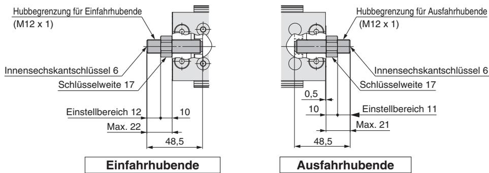
Stoßdämpfer/RJ **ZG** : Beidseitig **ZH** : Ausfahrhubende **ZJ** : Einfahrhubende **ZQ** : Einfahrhubende (Ausführung mit kürzerer Gesamtlänge)
