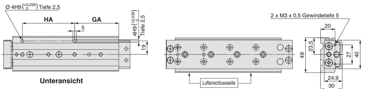
**Abmessungen** Alle nicht oben aufgeführten Abmessungen entsprechen der Standardausführung.
