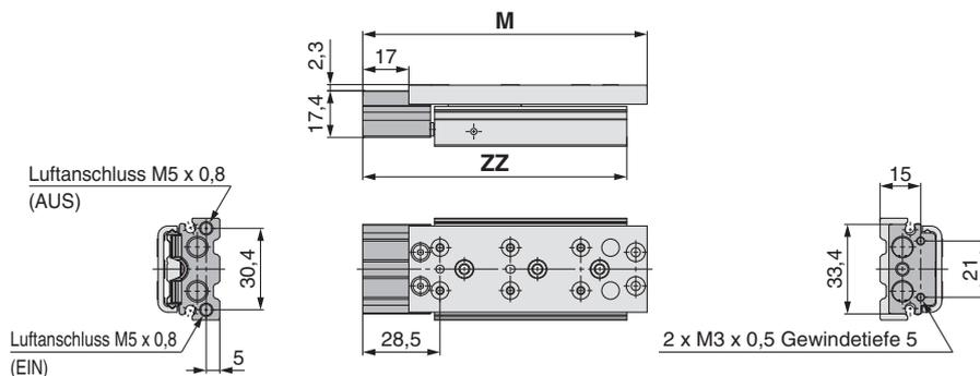
Alle nicht oben aufgeführten Abmessungen entsprechen der Standardausführung.
