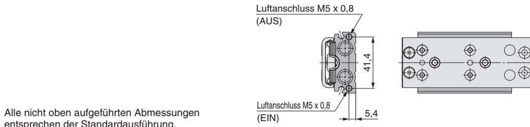
Alle nicht oben aufgeführten Abmessungen entsprechen der Standardausführung.
