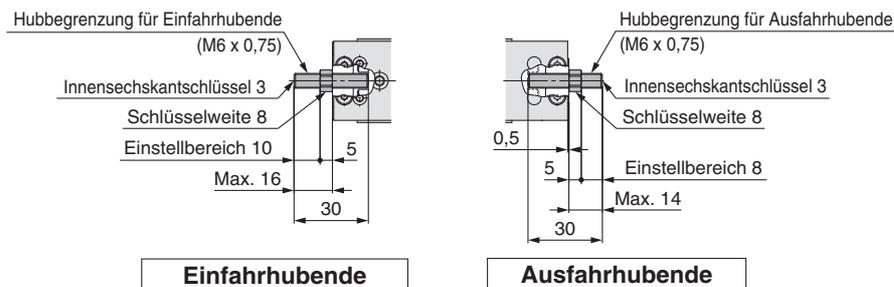
Metallanschlag **ZK**: Beidseitig **ZL**: Ausfahrhubende **ZM**: Einfahrhubende **ZT**: Einfahrhubende (Ausführung mit kürzerer Gesamtlänge)
