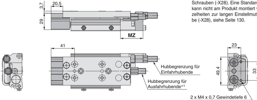
Alle nicht oben aufgeführten Abmessungen entsprechen der Standardausführung. Bei Kurzhüben kann der Signalgeber an bestimmten Punkten nicht montiert werden. Siehe Seite 126 für nähere Angaben.
