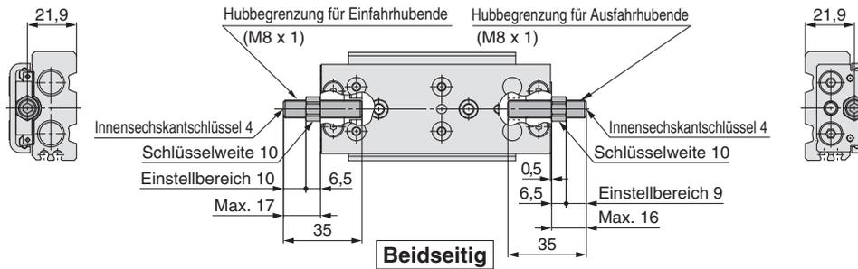
Gummianschlag **ZD** : Beidseitig **ZE** : Ausfahrhubende **ZF** : Einfahrhubende **ZP** : Einfahrhubende (Ausführung mit kürzerer Gesamtlänge)
