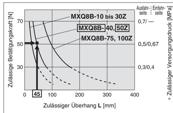
\* Der zulässige Versorgungsdruck auf Aus- und Einfahrseite ist die theoretische Zylinderkraft, wenn Betätigungskraft erforderlich ist.
