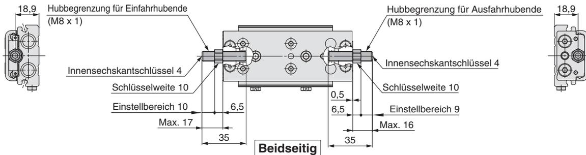
Gummianschlag **ZD** : Beidseitig **ZE** : Ausfahrhubende **ZF** : Einfahrhubende **ZP** : Einfahrhubende (Ausführung mit kürzerer Gesamtlänge)
