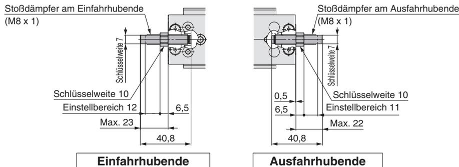
Alle nicht oben aufgeführten Abmessungen entsprechen der Standardausführung.
