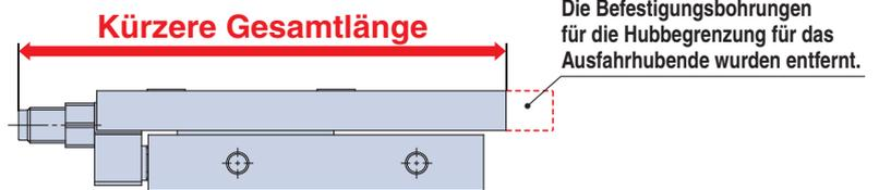
Die Befestigungsbohrungen für die Hubbegrenzung für das Ausfahrhubende wurden entfernt.
