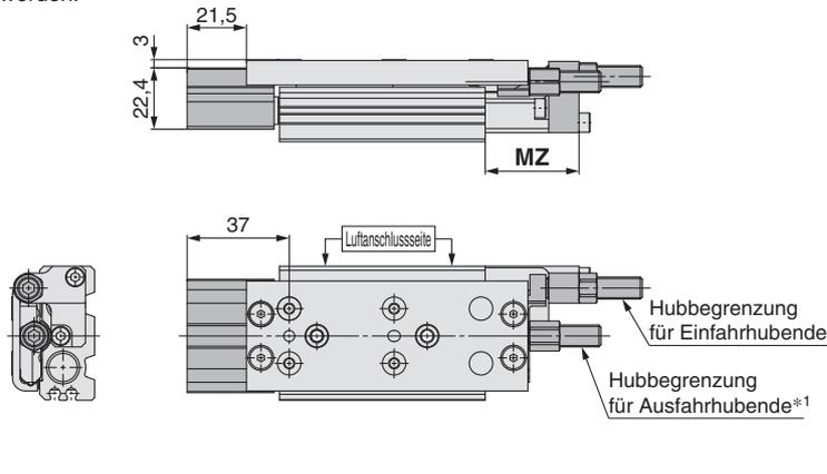
\*1 Die Hubbegrenzung für Ausfahrhubende (Stoßdämpfer) verwendet lange Einstellmutter und Schrauben (-X28). Eine Standardhubbegrenzung kann nicht am Produkt montiert werden. Für Einzelheiten zur langen Einstellmutter und -Schraube (-X28), siehe Seite 130.
