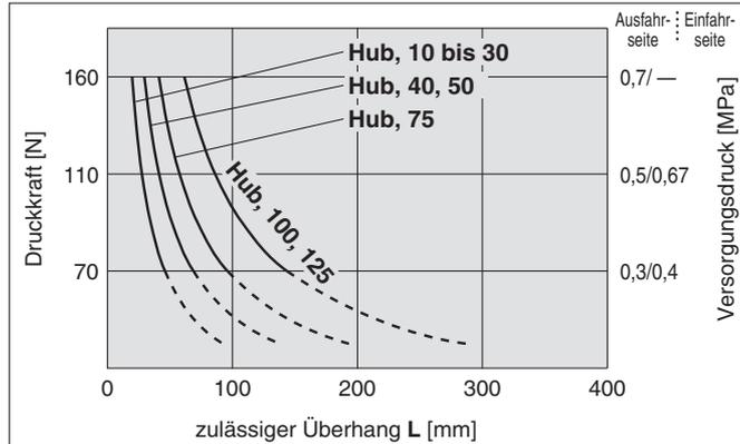
\* Die Druckkraft in den Bereichen mit gepunkteten Linien sind Referenzwerte, denn in diesen Bereichen kann die Druckkraft variieren.
