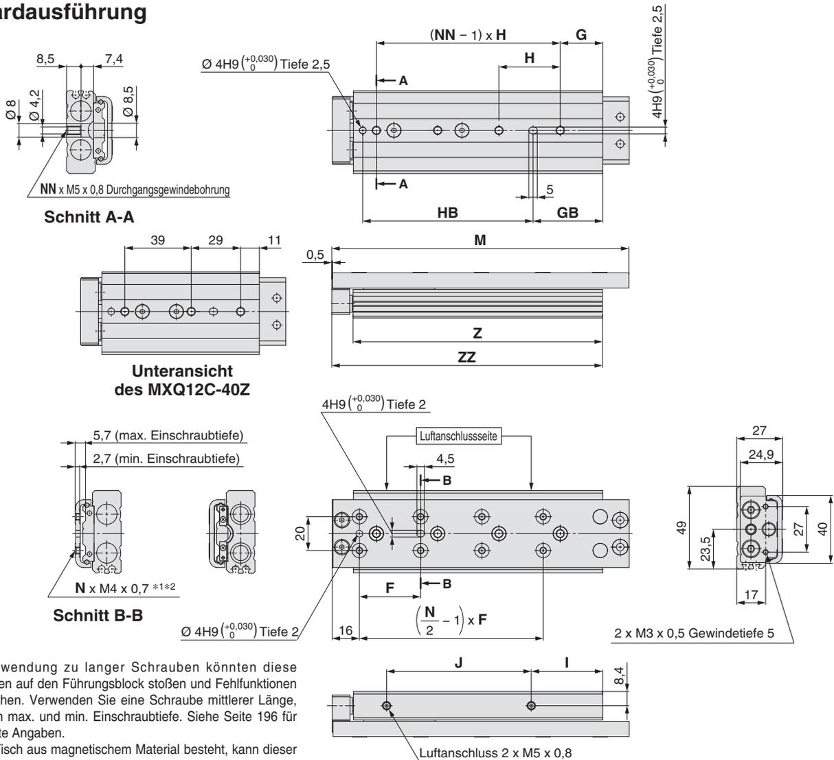
\*1 Bei Verwendung zu langer Schrauben könnten diese Schrauben auf den Führungsblock stoßen und Fehlfunktionen verursachen. Verwenden Sie eine Schraube mittlerer Länge, zwischen max. und min. Einschraubtiefe. Siehe Seite 196 für detaillierte Angaben.
