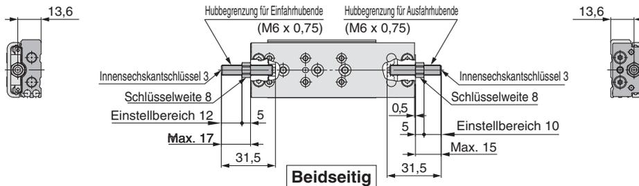
Stoßdämpfer/RJ **ZG**: Beidseitig **ZH**: Ausfahrhubende **ZJ**: Einfahrhubende **ZQ**: Einfahrhubende (Ausführung mit kürzerer Gesamtlänge)
