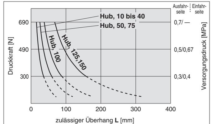
\* Die Druckkraft in den Bereichen mit gepunkteten Linien sind Referenzwerte, denn in diesen Bereichen kann die Druckkraft variieren.
