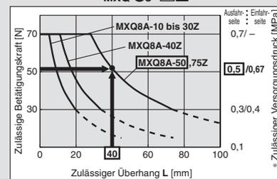
\* Der zulässige Versorgungsdruck auf Aus- und Einfahrseite ist die theoretische Zylinderkraft, wenn Betätigungskraft erforderlich ist.
