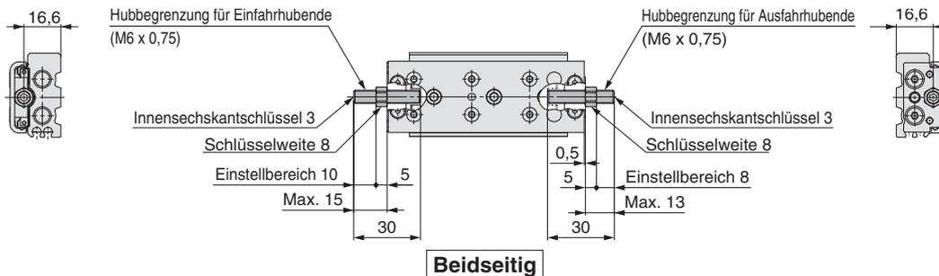
Gummianschlag **ZD** : Beidseitig **ZE** : Ausfahrhubende **ZF** : Einfahrhubende **ZP** : Einfahrhubende (Ausführung mit kürzerer Gesamtlänge)
