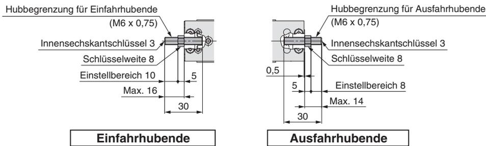
Metallanschlag **ZK**: Beidseitig **ZL**: Ausfahrhubende **ZM**: Einfahrhubende **ZT**: Einfahrhubende (Ausführung mit kürzerer Gesamtlänge)
