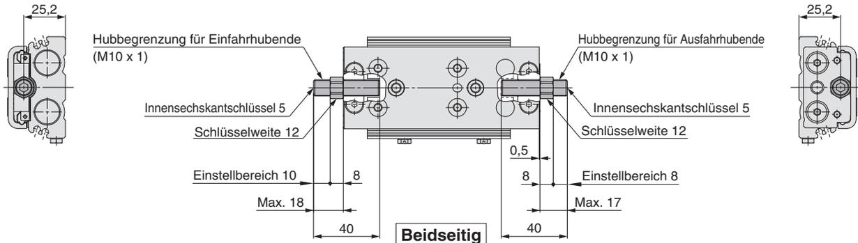
Gummianschlag **ZD** : Beidseitig **ZE** : Ausfahrhubende **ZF** : Einfahrhubende **ZP** : Einfahrhubende (Ausführung mit kürzerer Gesamtlänge)
