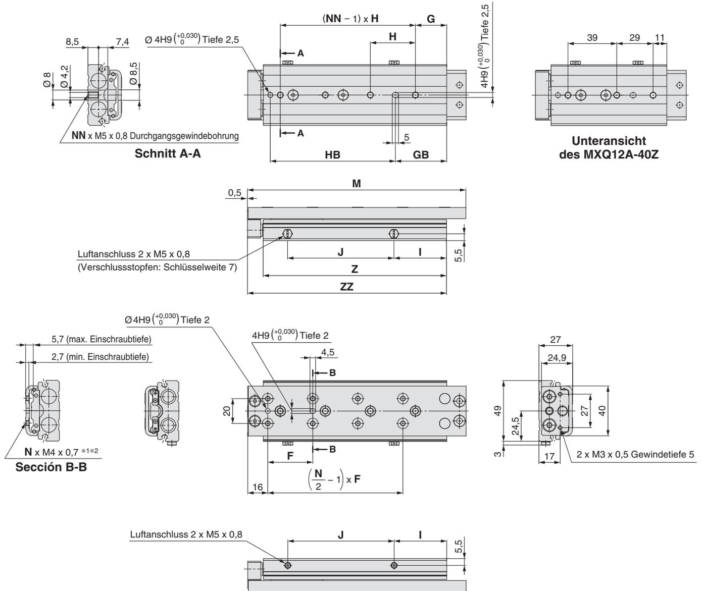
\*1 Bei Verwendung zu langer Schrauben könnten diese Schrauben auf den Führungsblock stoßen und Fehlfunktionen verursachen. Verwenden Sie eine Schraube mittlerer Länge, zwischen max. und min. Einschraubtiefe. Siehe Seite 196 für detaillierte Angaben.
