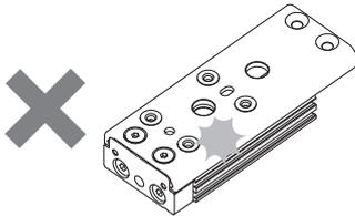
**3. Das Produkt darf beim Montieren eines Werkstücks keinen übermäßigen Stößen oder Lasten ausgesetzt werden.**
