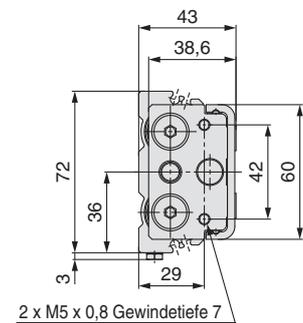
\*1 Bei Verwendung zu langer Schrauben könnten diese Schrauben auf den Führungsblock stoßen und Fehlfunktionen verursachen. Verwenden Sie eine Schraube mittlerer Länge, zwischen max. und min. Einschraubtiefe. Siehe Seite 196 für detaillierte Angaben.
