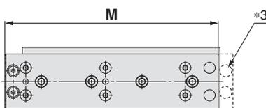
\*3 Da die Gesamtlänge durch Beseitigung der Befestigungsbohrungen für die Hubbegrenzung für das Ausfahrhubende verringert wurde, kann nachträglich kein Ausfahrhubende montiert werden. Die Hubbegrenzungen für das Einfahrhubende können nachträglich montiert werden.
