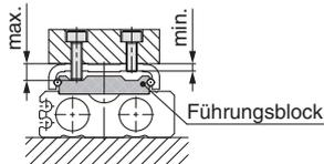
**⚠ Achtung** Um zu verhindern, dass die Schraube, mit der das Werkstück fixiert wird, an den Schlitten stößt, verwenden Sie bitte Schrauben, die mindestens 0,5 mm kürzer sind als die maximale Einschraubtiefe. Zu lange Schrauben könnten auf den Führungsblock stoßen und Fehlfunktionen usw. verursachen.
