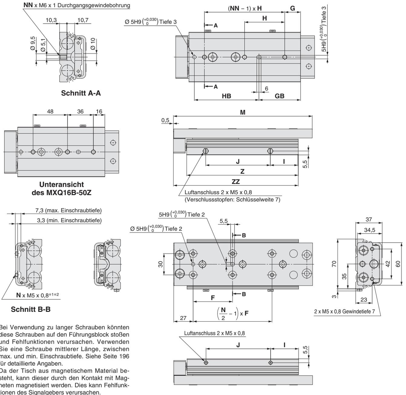
\*1 Bei Verwendung zu langer Schrauben könnten diese Schrauben auf den Führungsblock stoßen und Fehlfunktionen verursachen. Verwenden Sie eine Schraube mittlerer Länge, zwischen max. und min. Einschraubtiefe. Siehe Seite 196 für detaillierte Angaben.
