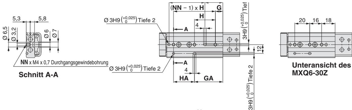
\*1 Bei Verwendung zu langer Schrauben könnten diese Schrauben auf den Führungs-block stoßen und Fehlfunktionen verursachen. Verwenden Sie eine Schraube mittlerer Länge, zwischen max. und min. Einschraubtiefe. Siehe Seite 196 für detail-lierte Angaben.
