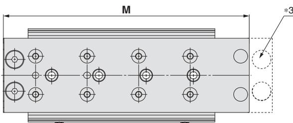
\*3 Da die Gesamtlänge durch Beseitigung der Befestigungsbohrungen für die Hubbegrenzung für das Ausfahrhubende verringert wurde, kann nachträglich kein Ausfahrhubende montiert werden. Die Hubbegrenzungen für das Einfahrhubende können nachträglich montiert werden.
