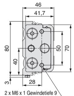
\*1 Bei Verwendung zu langer Schrauben könnten diese Schrauben auf den Führungsblock stoßen und Fehlfunktionen verursachen. Verwenden Sie eine Schraube mittlerer Länge, zwischen max. und min. Einschraubtiefe. Siehe Seite 196 für detaillierte Angaben.
