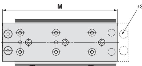
\*3 Da die Gesamtlänge durch Beseitigung der Befestigungsbohrungen für die Hubbegrenzung für das Ausfahrhubende verringert wurde, kann nachträglich kein Ausfahrhubende montiert werden. Die Hubbegrenzungen für das Einfahrhubende können nachträglich montiert werden.
