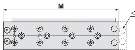
\*3 Da die Gesamtlänge durch Beseitigung der Befestigungsbohrungen für die Hubbegrenzung für das Ausfahrhubende verringert wurde, kann nachträglich kein Ausfahrhubende montiert werden. Die Hubbegrenzungen für das Einfahrhubende können nachträglich montiert werden.
