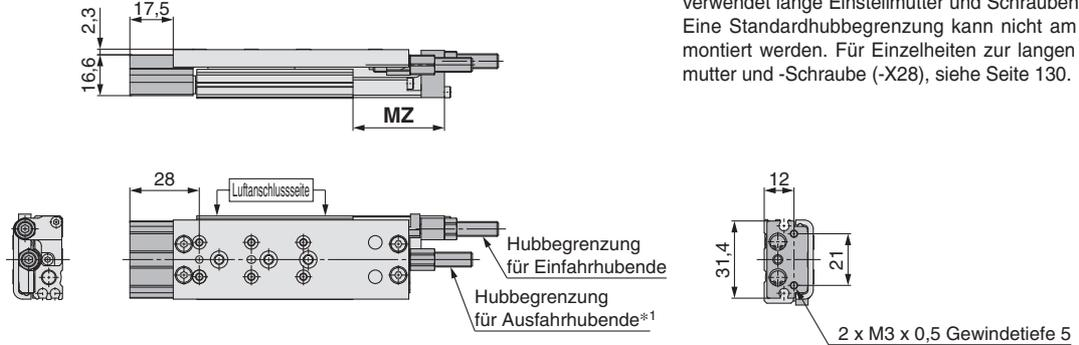
\*1 Die Hubbegrenzung für Ausfahrhubende (Stoßdämpfer) verwendet lange Einstellmutter und Schrauben (-X28). Eine Standardhubbegrenzung kann nicht am Produkt montiert werden. Für Einzelheiten zur langen Einstellmutter und -Schraube (-X28), siehe Seite 130.
