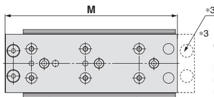
Da die Gesamtlänge durch Beseitigung der Befestigungsbohrungen für die Hubbegrenzung für das Ausfahrhubende verringert wurde, kann nachträglich kein Ausfahrhubende montiert werden. (Die Hubbegrenzungen für das Einfahrhubende können nachträglich montiert werden.)
