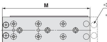
\*3 Da die Gesamtlänge durch Beseitigung der Befestigungsbohrungen für die Hubbegrenzung für das Ausfahrhubende verringert wurde, kann nachträglich kein Ausfahrhubende montiert werden. Die Hubbegrenzungen für das Einfahrhubende können nachträglich montiert werden.
