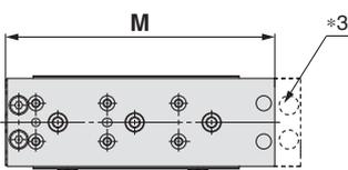
\*3 Da die Gesamtlänge durch Beseitigung der Befestigungsbohrungen für die Hubbegrenzung für das Ausfahrhubende verringert wurde, kann nachträglich kein Ausfahrhubende montiert werden. Die Hubbegrenzungen für das Einfahrhubende können nachträglich montiert werden.
