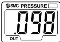
Questa funzione elimina le piccole differenze nei valori di uscita dei 4 canali e favorisce l'uniformità tra i numeri visualizzati. I valori visualizzati dei sensori di pressione possono essere regolati con una tolleranza del  $\pm 5\%$  per la serie ISE e del  $\pm 2.5\%$  per la serie ZSE.
