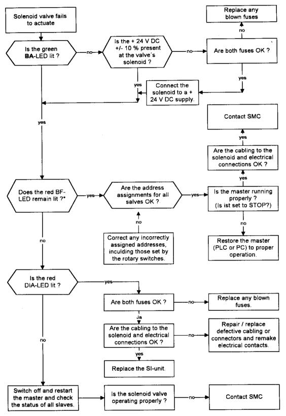
Nach dem Einschalten kann es während der Hochlaufphase (Standard-Einstellung: 20 Sekunden) vorkommen, daß die SI-Einheit als Slave zu spät vom Master (z.B. IM308B,C) erkannt wird, obwohl alle 3 LEDs auf der SI-Einheit keinen Fehler anzeigen (d. h. nur grüne LED ist an). In diesem Fall genügt ein Neustart des Masters. Die Versorgungspannung für die Slaves sollte grundsätzlich vor der des Masters einschwingen.
