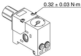
3. Anzugsdrehmoment für Blindplatten und Manometer-Befestigungsschrauben auf einem Reglerblock
