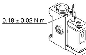
5. Anzugsmoment für Klemmschraube der DIN-Schiene an den Endplatten
