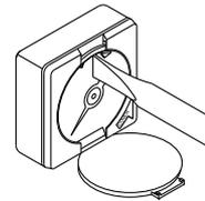
3. Schließen Sie die Schutzkappe in Pfeilrichtung, bis Sie hörbar einrastet.
