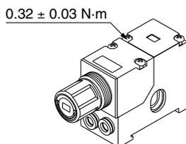
4. Anzugsmoment für Befestigungsschrauben des Druckschalters an gemeinsamem Versorgungsblock mit Druckschalter und/oder Druckschalterblock
