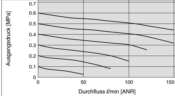
ARM11AA1-307-1 (Steckverbindungen: EIN  $\varnothing 6$ , AUS  $\varnothing 4$ ) Bedingungen: Eingangsdruck 0.5 MPa
