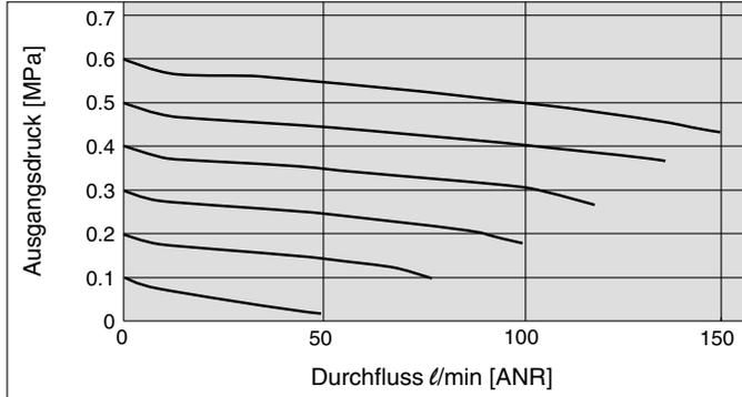
**ARM11BA1-306-1 (Steckverbindungen: EIN/AUS  $\varnothing 4$ )** Bedingungen: Eingangsdruck 0.5 MPa
