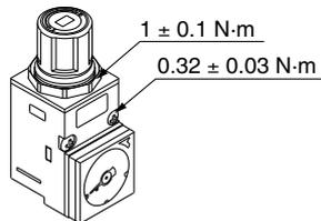
2. Anzugsdrehmoment für Regler-Befestigungsschrauben auf einem Reglerblock
