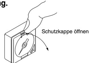
2. Verschieben Sie die Manometerzeiger z. B. mit einem Flachsraubendreher.
