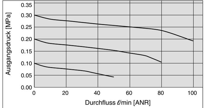
**ARM11BA1-307 (Steckverbindungen: EIN  $\varnothing 6$ , AUS  $\varnothing 4$ )** Bedingungen: Eingangsdruck 0.7 MPa
