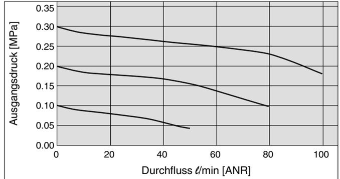
**ARM11BA1-308 (Steckverbindungen: EIN/AUS  $\varnothing 6$ )** Bedingungen: Eingangsdruck 0.7 MPa
