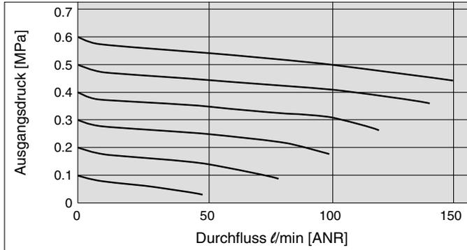
**ARM11BA1-307-1 (Steckverbindungen: EIN  $\varnothing 6$ , AUS  $\varnothing 4$ )** Bedingungen: Eingangsdruck 0.5 MPa
