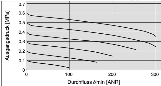
**ARM11BA1-308-1 (Steckverbindungen: EIN/AUS  $\varnothing 6$ )** Bedingungen: Eingangsdruck 0.5 MPa
