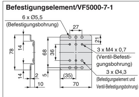
Bestell-Nr. Schraube: VF5000-17-1 (M4 x 37, mit Federring)
