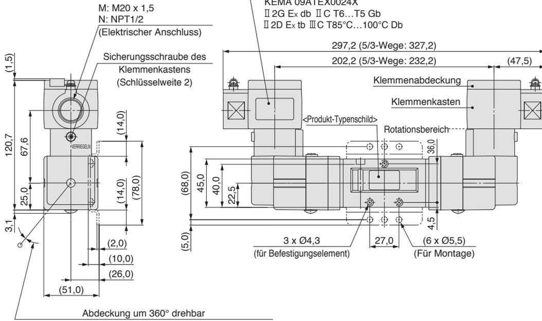
\* Entfernen Sie die Sicherungsschraube der Abdeckung vor der Drehung.
