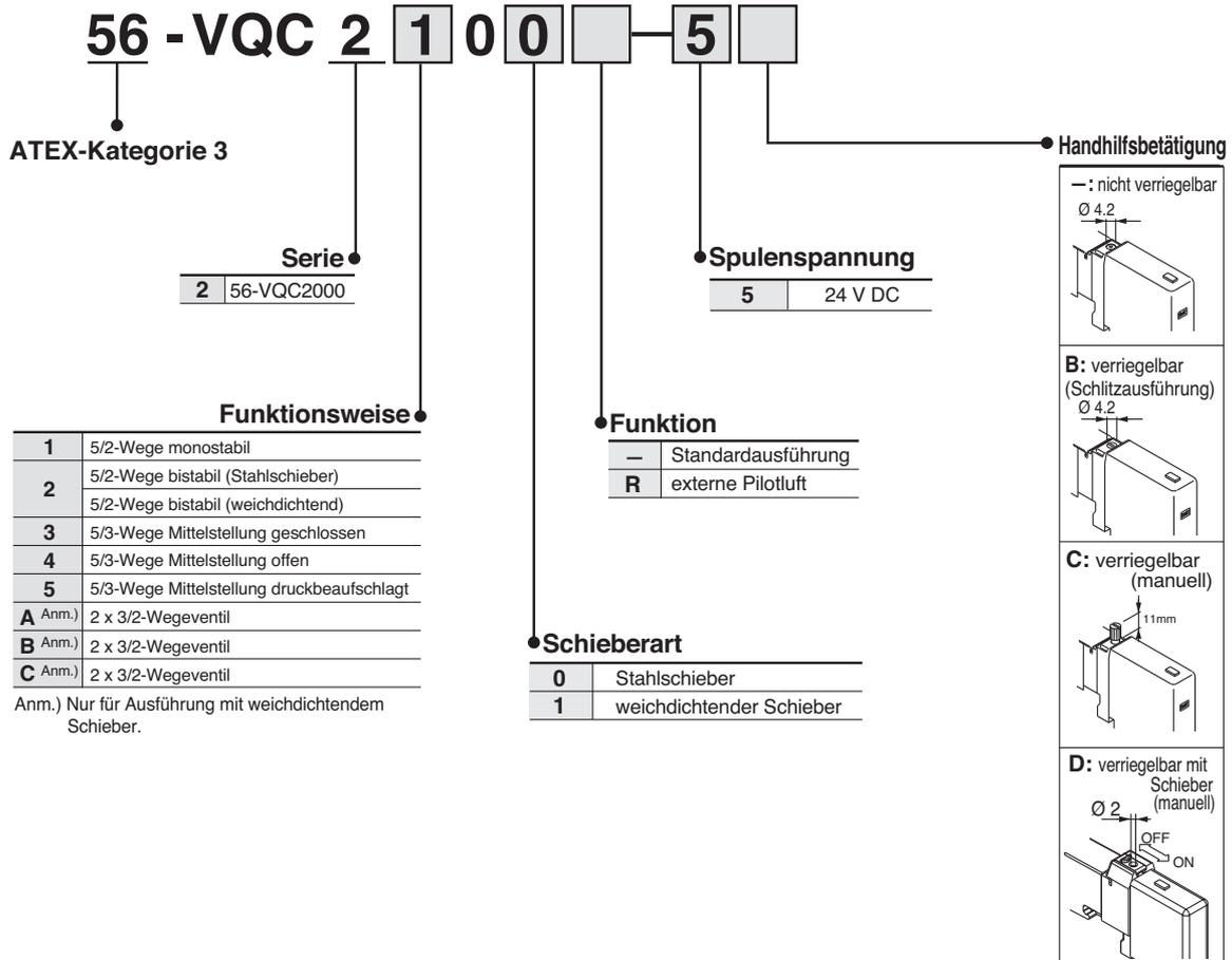
Anm.) Die Magnetventile "56-" sollten an die Mehrfachanschlussplatte "56-VV5QC21" angeschlossen werden.
