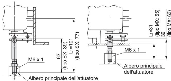
Montaggio laterale con assieme leva a forcella MX
