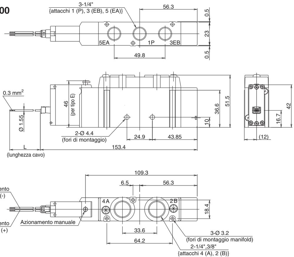
**Modello con connettore ad innesto con protezione (LL)**
