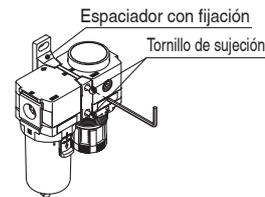
Aprieta 2 dos tornillos de sujeción del espaciador con la fijación o el espaciador uniformemente.
