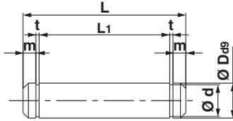
Material: Der Bolzen und der Sicherungsring sind aus rostfreier Stahl 304
