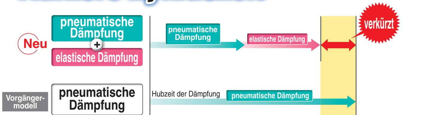
■ Elastische Dämpfung reduziert Stoßgeräusch beim Erreichen der Endlage
