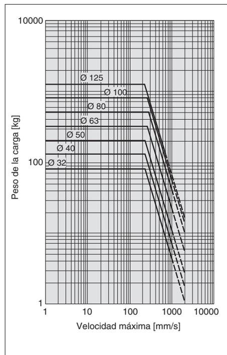
(Ejemplo) Encuentre el límite superior de carga del extremo del vástago para un cilindro neumático de Ø 63 operado a 500 mm/s. Desde el punto que indica 500 mm/s en el eje de abcisas, trace una línea hacia arriba y calcule el punto de intersección con la línea del diámetro 63. Trace una línea desde el punto de intersección hacia la izquierda para hallar un peso de carga de 80 kg.
