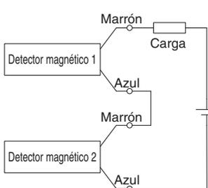
Quando dos detectores se conectan en serie, se puede producir un funcionamiento defectuoso debido a la disminución de la tensión de carga en el estado ON. Los Led indicadores se encenderán cuando ambos detectores estén en estado ON. Los detectores magnéticos con la tensión de carga de menos de 20 V no se pueden utilizar.
