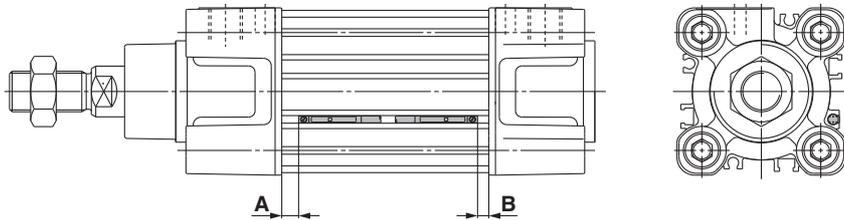
Posición adecuada de montaje del detector magnético [mm]
