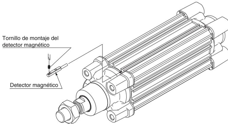
• Para apretar el tornillo de montaje del detector magnético, use un destornillador de relojero de un diámetro de empuñadura de 5-6 mm.
