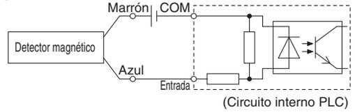
Conecte según las características técnicas, dado que el modo de conexión variará en función de las entradas al PLC.
