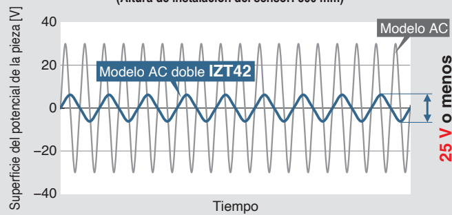
Comparación de la amplitud de potencial entre el modelo AC y el modelo AC doble (Altura de instalación del sensor: 300 mm)
