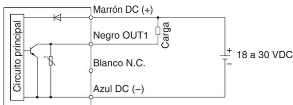
Tensión aplicada máx.: 30 V, Corriente de carga máx.: 80 mA, Caída de tensión interna: 1.5 V o menos
