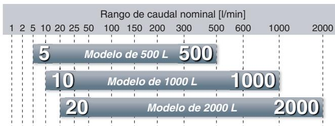
Incremento mínimo ajustable **1 l/min**
