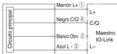
\* Los números de los diagramas del circuito muestran la disposición de pins del conector.
