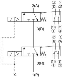
**externe Pilotluft / mit Rückschlagventil**
