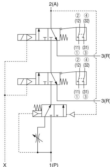
**externe Pilotluft / mit Rückschlagventil**
