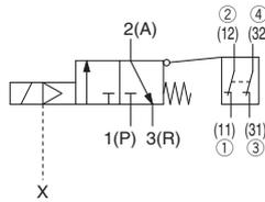
**externe Pilotluft / mit Rückschlagventil**
