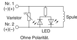
Anm.) Beachten Sie, dass bei der Funkenlöschung mit Varistor eine Restspannung von ca. 1 V auftritt.
