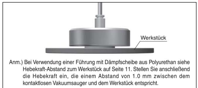
Anm.) Bei Verwendung einer Führung mit Dämpfscheibe aus Polyurethan siehe Hebekraft-Abstand zum Werkstück auf Seite 11. Stellen Sie anschließend die Hebekraft ein, die einem Abstand von 1.0 mm zwischen dem kontaktlosen Vakuumsauger und dem Werkstück entspricht.
