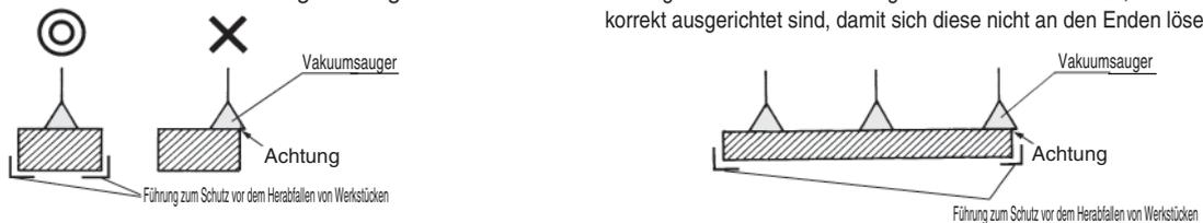
Installieren Sie Hilfsgeräte (Beispiel: Führung, die ein Herabfallen von Werkstücken verhindert), soweit nötig.
