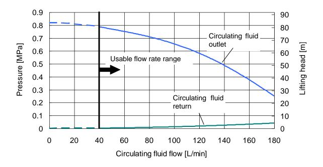
Fig. 8-18: Pump capacity (HRSH250/300-A\*-20/40-\*)
