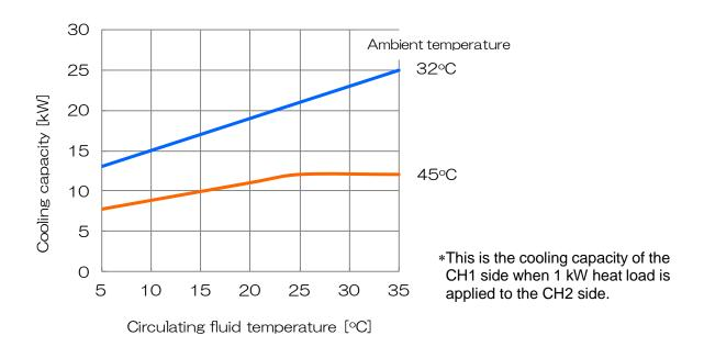
Fig. 8-6 Cooling Capacity (HRL200-A\*-20)
