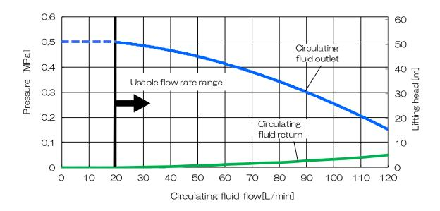
Fig. 8-9 Pump capacity(HRL100-A\*-20 CH1)
